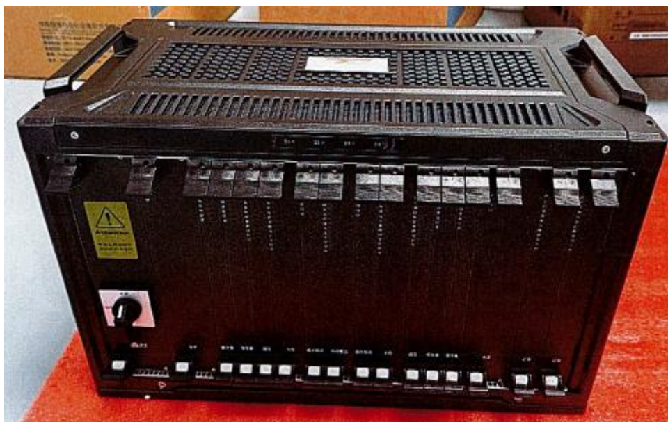
图1-2 LKJ-15S(分布式)列车运行监控系统硬件图片
