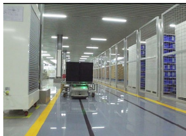
AGV 搬运机器人
